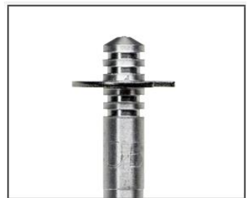
C形卡环在喷管针阀上的位置决定了发动机在中速时的空燃比。
